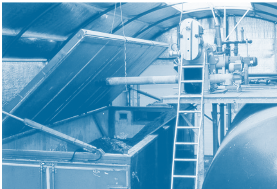
Figuur 2 Afscheiding van dikke fractie uit varkensdrijfmest door middel van vijzelpers en centrifuge (Dirven, Someren).
