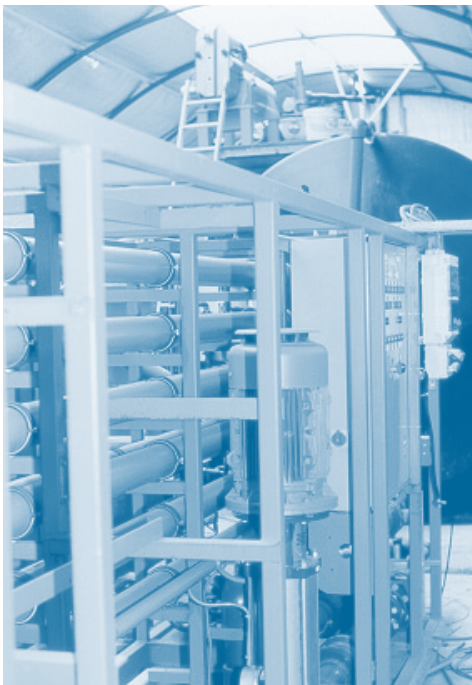
Figuur 3 Microfiltratie-installatie voor behandeling van dunne fractie uit varkensdrijfmest na afscheiding vaste fractie met vijzelpers en centrifuge (Dirven, Someren)
