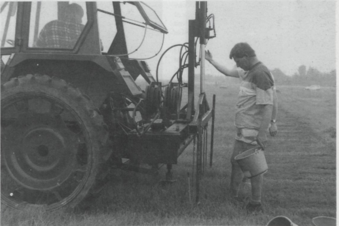
Met dit grondmonsterapparaat kunnen maximaal vijf grondmonsters per keer genomen worden.
