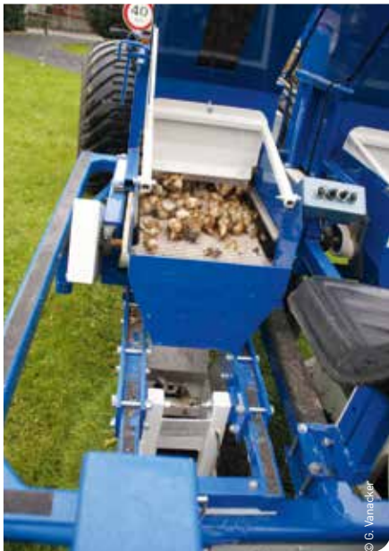
▲ Plantmachine: de snelheid van de aanvoerband wordt elektronisch gestuurd
