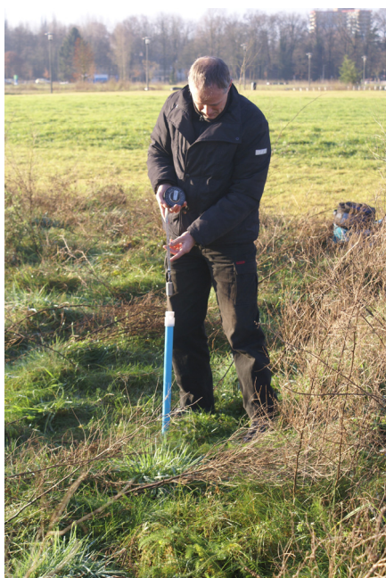
Figuur 1 Opname van de grondwaterstand in een peilbuis gebruik makend van een meetlint met klokje
