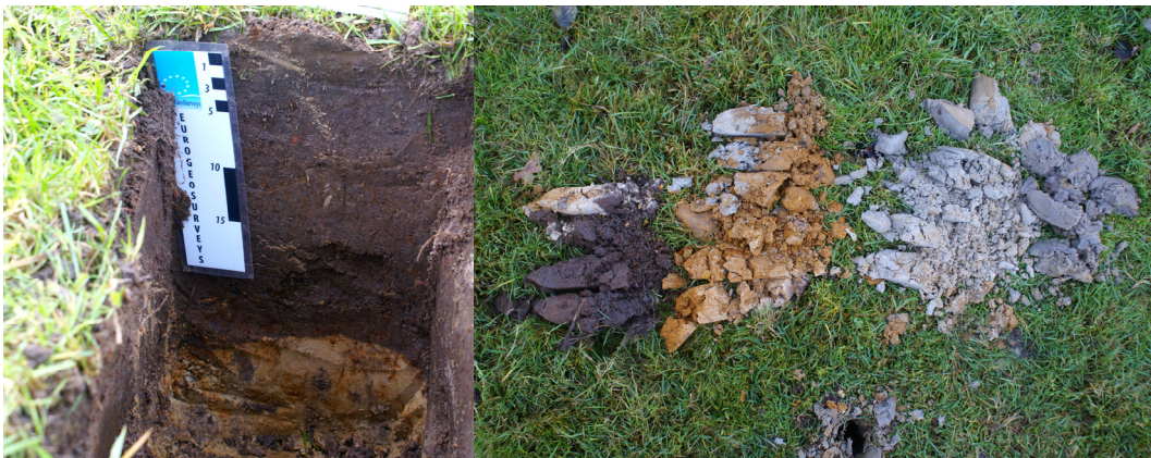
Figuur 2 Veldschatting van de GxG uit landschappelijke kenmerken (boven) en profielkenmerken in een profielkuil (links onder) en uit een boring (rechts onder)
