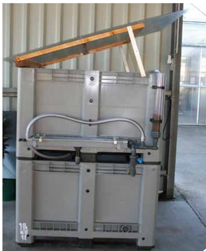
▲ Demo-opstelling van de biofilter
