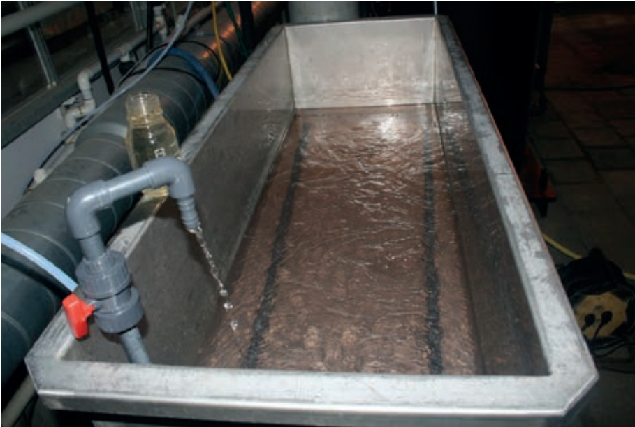
Figuur II.4 Ozon wordt in een deelstroom toegevoegd aan het water, waarna na een bepaalde reactietijd een deelstroom langs een UV-lamp wordt geleid. Ozon zorgt voor een roze verkleuring van het water, doordat ook mangaan wordt omgezet in permanganaat. Toepassen van UV zorgt dat de roze verkleuring weer verdwijnt, doordat permanganaat wordt omgezet in mangaanoxide.
