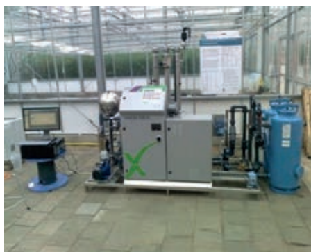
Figuur II.2 a Peroxide wordt toegevoegd aan de waterstroom, waar het onder invloed van UV-licht wordt omgezet in hydroxyl-radicalen, die reageren met de GBM. b. H 2 O 2 -MDUV opstelling van Priva c. H 2 O 2 -LDUV opstelling van HortiMaX.
