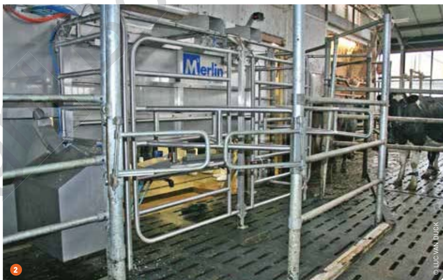
1 De M 2 erlin is voorzien van een nieuwe energie-efficiënte aansluitarm en een touchscreen voor eenvoudiger koemanagement. 2 De M 2 erlin kan dienst doen als separatiehek, door koeien buiten te laten langs de zij-uitgang (op de foto in open positie) of rechtdoor.
