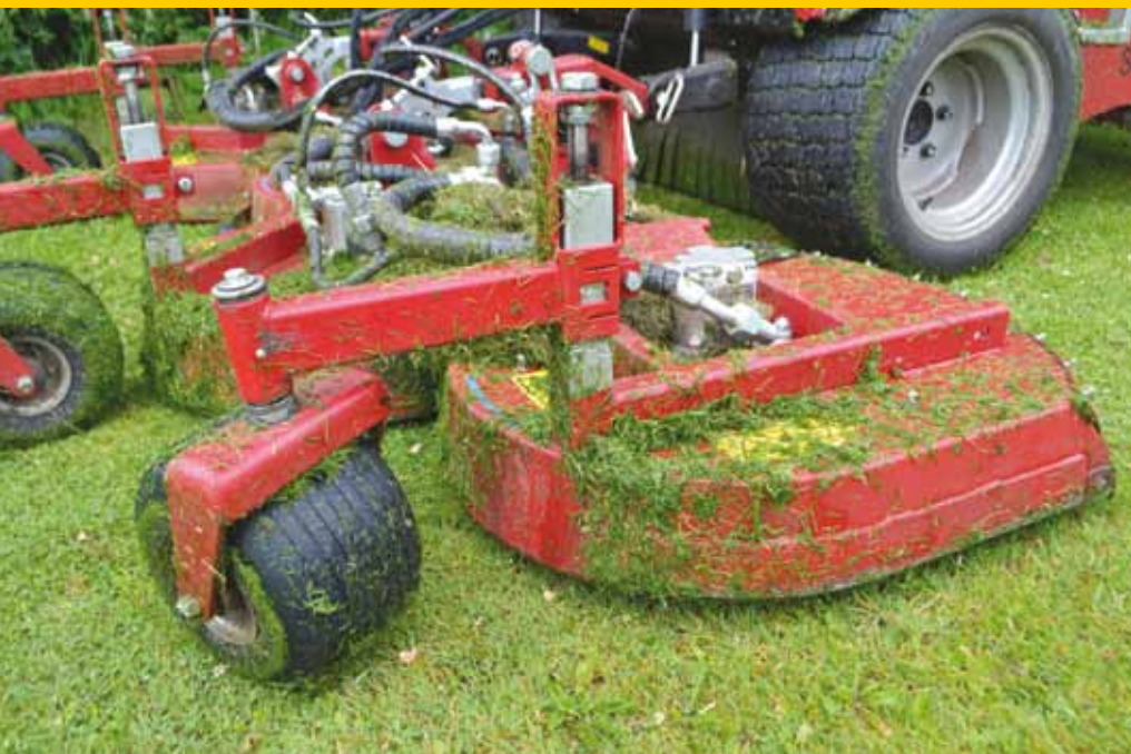
Steunwielen en hoogte-instelling cirkelmaaidekken. Net als het dek zelf en de achterrollen voor mooier maaiwerk robuust en functioneel. Twee van de vijf dekken hebben een andere draairichting.
