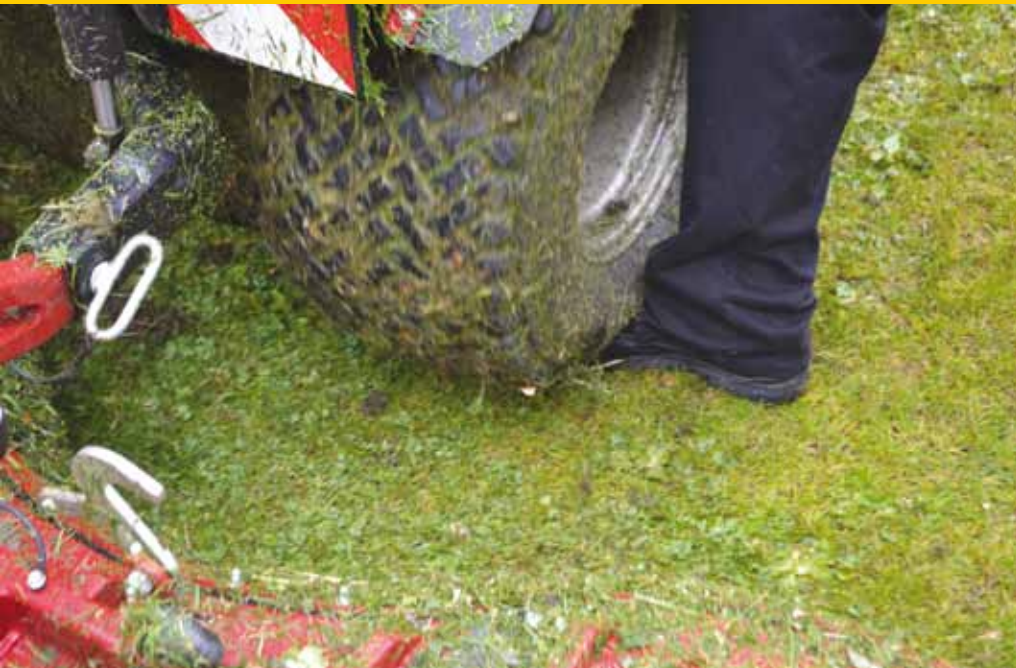
Lage bodemdruk bewezen door iemand over de voeten te rijden.
