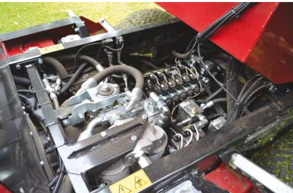
Onder de cabine liggen twee hydropompen met elk een debiet van 65 l/min.. Zowel de dekken als de permanente vierviel aandrijving worden ermee aangedreven. Een groot oliereservoir van 75 l voorkomt 's zomers oververhitting van de olie.
