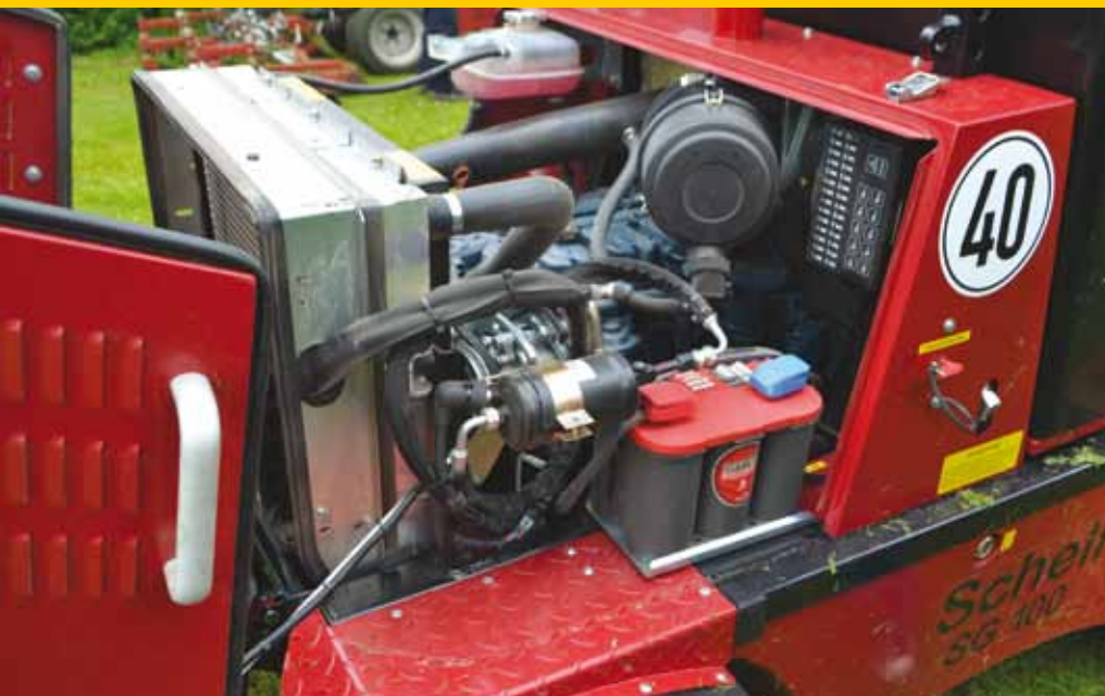
Een 3 liter 100 pk VM-stage IIIA-motor. De viercilinder-dieselmotor is gereduceerd tot 85 pk: stiller, zuiniger (4,5-5,0 liter per uur) en hoger koppel (290 Nm/1400 toeren). Het gaat om een stage IIIA-motor deze kan optioneel met roetfilter worden uitgevoerd.
