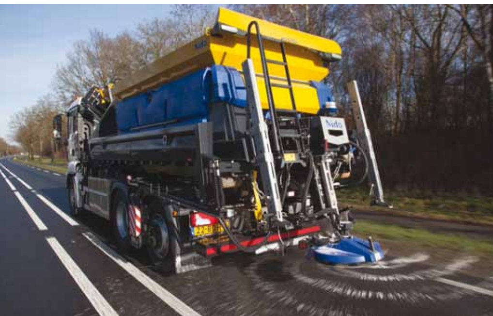
De Stratos 3 met de meest luxe besturingsuitvoering, de Evolution-line genaamd, is volledig geschikt voor 'dynamisch strooien'.
