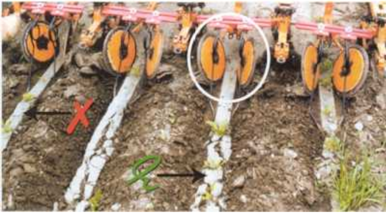
De slechte werkdiepteregeling en de tijdrovende instelling met klem-bouten maken het moeilijk om het gewenste effect te bereiken.
