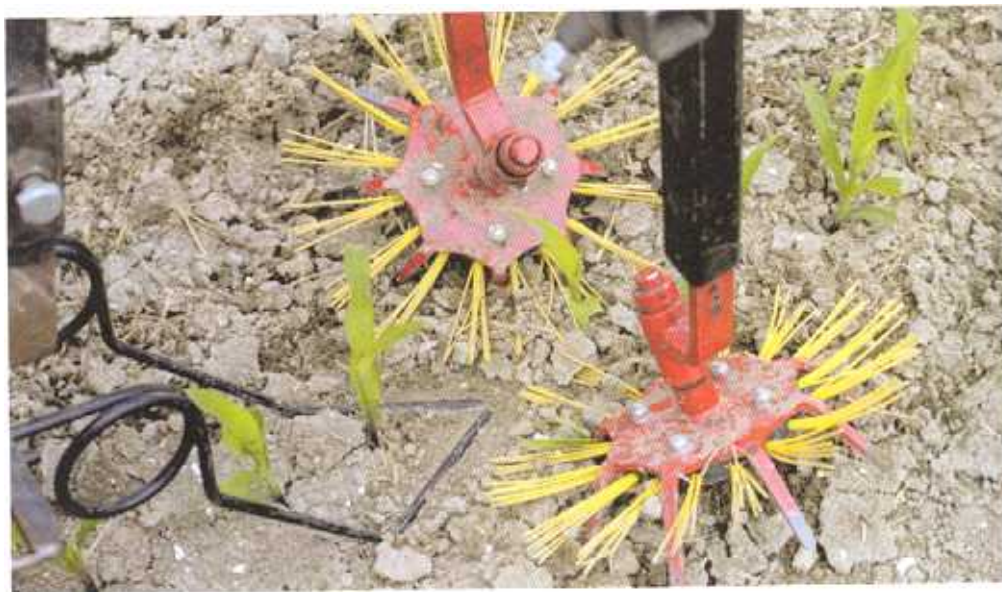
Mechanische onkruidbestrijding met een schoffelborstelwieder (links) en torsieborstelwieder (rechts).
