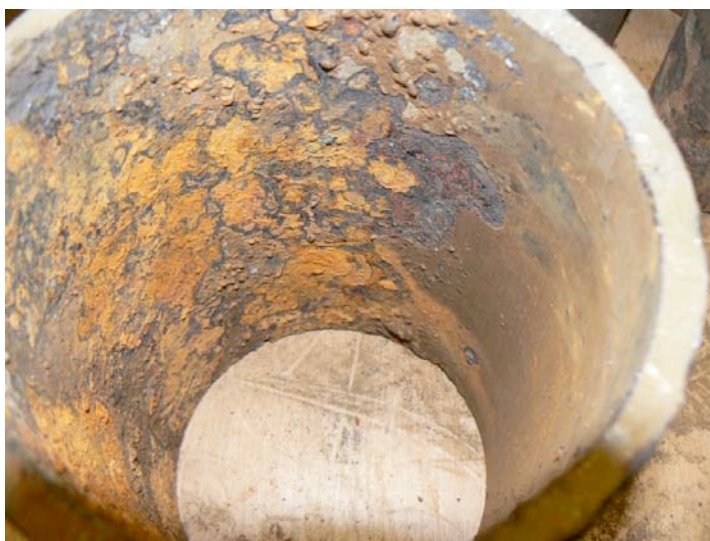
Afbeelding 2. Grijs gietijzeren leiding met coating
