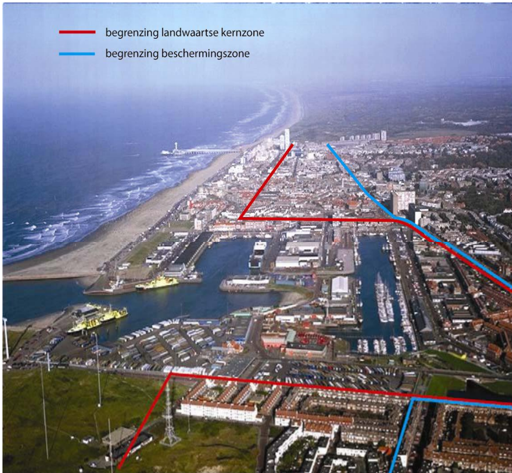
Figuur 4.11 Opbouw van de waterkeringszone in Scheveningen in huidige toestand, waar de ligging van de waterkering niet herkenbaar is (Arcadis-Alkyon, (2005).
