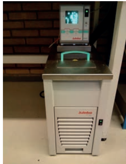
Fig. 3.1. Koelmachine en koelblok die zijn gebruikt voor het meten van loopactiviteit bij roofmijten.
