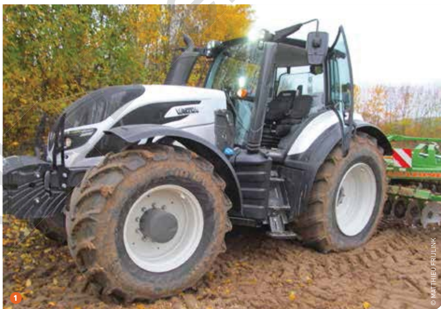
1 De nieuwe cabine is iets verder naar voren gebouwd zodat de spatbordkasten minder ruimte innemen. Deze cabine is voldoende getest om ook in de bosbouw aan de slag te kunnen. 2 De nieuwe Valtra T krijgt een nieuwe cabine en motorkap waardoor het zicht van de bestuurder op zijn werk duidelijk verbetert.
