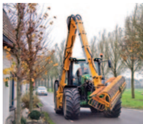
Bij transport is de Grenadier per definitie hoog. Een dakluik of -raam in de cabine is wenselijk.
