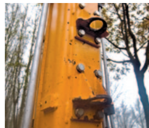
Met een dubbel aanpikoog is de arm met een smal werktuig lager te transporteren.
