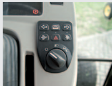
Met een knop kun je het reinigen van het roetfilter uitstellen. Tot je klaar bent met maaien, bijvoorbeeld.
