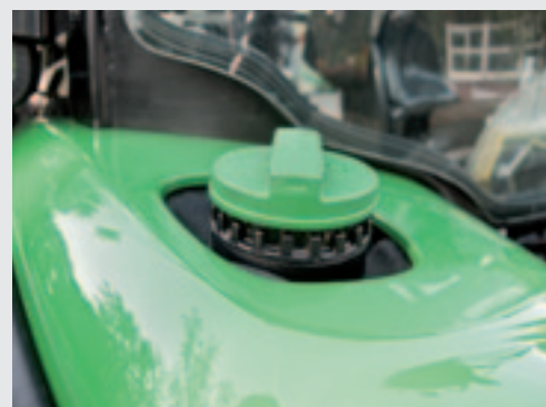
De dieseltank is geïntegreerd in het spatbord. De tankdop is voortaan John Deere-groen.
