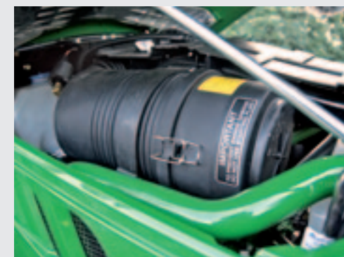
Het luchtfilter in de 3R is lastig te openen. Bij de 4R gaat dat iets makkelijker.
