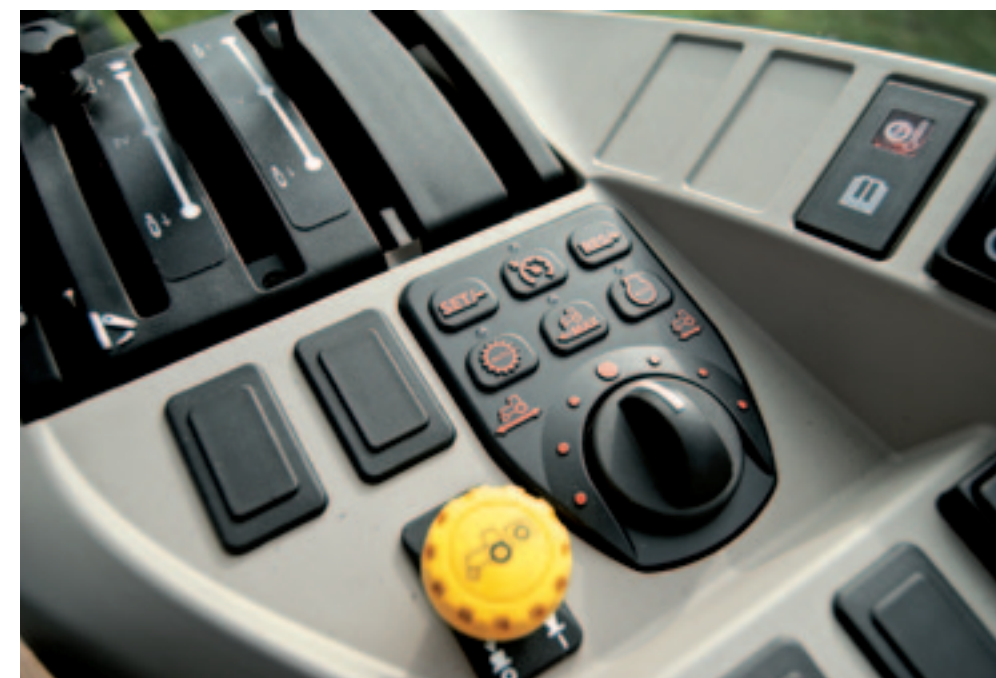
Op het zwarte paneeltje bedien je de elektronica. Met de bovenste drie knopjes bedien je de cruise control, de onderste drie zijn voor LoadMatch, SpeedMatch en het koppelen van motortoerental en rijsnelheid aan het rijpedaal.
