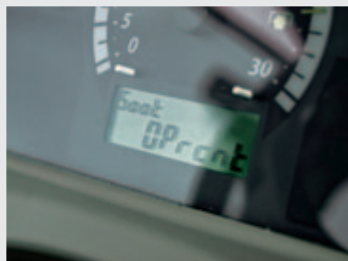
Als het roetfilter vol is, gaat de trekker regenereren. Het filter van deze 4066R is nog helemaal schoon: nul procent roet.
