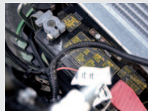
Onder de makkelijk te openen motorkap zijn de accupolen redelijk goed te bereiken. De radiatoren reinigen is lastig.
