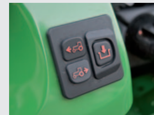
Met HitchAssist kun je de trekker met knoppen op het spatbord heel langzaam voor- of achterwaarts laten rijden.
