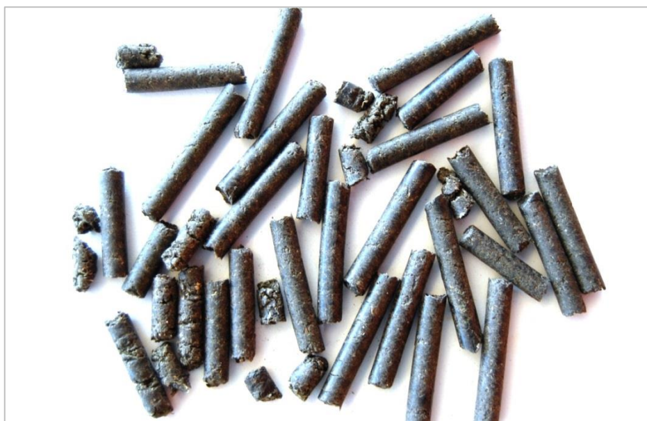
Figuur 26: Standaardpellets, na twee keer persen. Ze lijken op kalverbrokken en ze zijn stevig en stuiven niet
