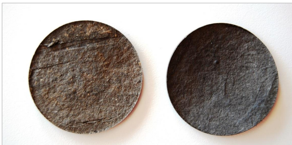
Figuur 24: TORWASH-pellets: links van waterpest, rechts van Cabomba
