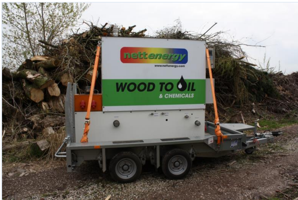
Figuur 3: De pyrolysemachine komt naar de productieplek van de biomassa
