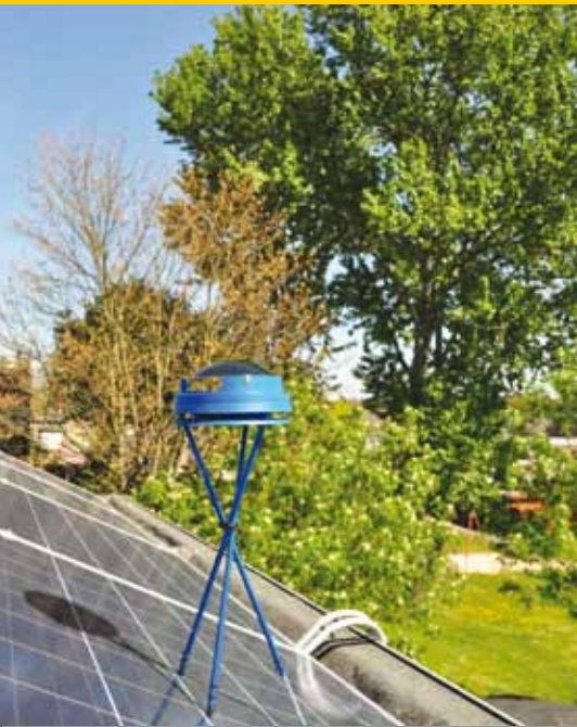
De Zonnepadvinder bij een onderzoek naar mogelijke schaduw door de populieren op de achtergrond
