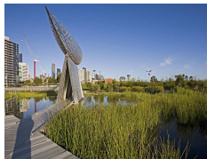
36. Rietvelden in Docklands om regenwater vast te houden en te zuiveren voor het in de baai komt.
