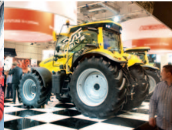
Traploze McCormick We hebben er even op moeten wachten, maar daar is hij dan toch: de McCormick X6 en X7 met een traploze bak van ZF. Voor de gelegenheid had McCormick de trekkers met VT Drive eenmalig knalgeel gespoten. De bak heeft vier snelheidsbereiken.
