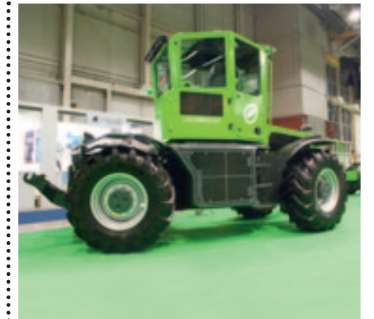
Merlo-werktuigendrager Merlo toonde een prototype van een werktuigendrager. De trekker heeft een hef en mechanische aftakas aan de achterkant. Aan de zijkant en voorzijde kunnen machines aan gebouwd worden. De stuurkolom en stoel kunnen in drie richtingen worden gezet.
