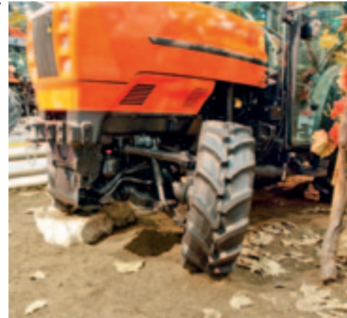
Onafhankelijke voorwielvering Same Deutz-Fahr heeft voor de Same-fruitteeltrekker serie een onafhankelijke voorwielvering ontwikkeld. Volgens een zegsman heeft het concern de intentie om de technologie door te ontwikkelen voor de boerenmodellen van Same Deutz-Fahr.
