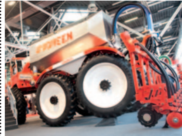
Digestaat-bemester Om het stikstofrijke digestaat uit te rijden in de mais op het moment dat het gewas het nodig heeft, ontwikkelde Unigreen de zeswielige Talpa. De zelfrijder heeft een knik achter de vooras, de achterste as stuurt mee. Misschien een idee voor in de aardappelen?
