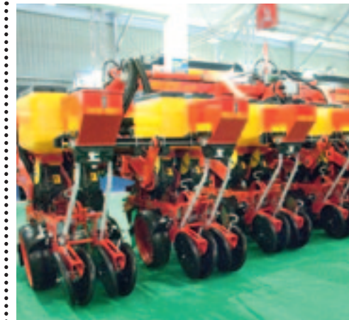
Delta-zaaimachine van MaterMacc De Italiaanse fabrikant MaterMacc heeft een zogeheten delta-maiszaaimachine gebouwd, waarbij telkens twee zaai-elementen tegen elkaar aan zijn gezet. Idee van het zaai-principe is dat de plantjes meer ruimte hebben om zich te ontwikkelen.
