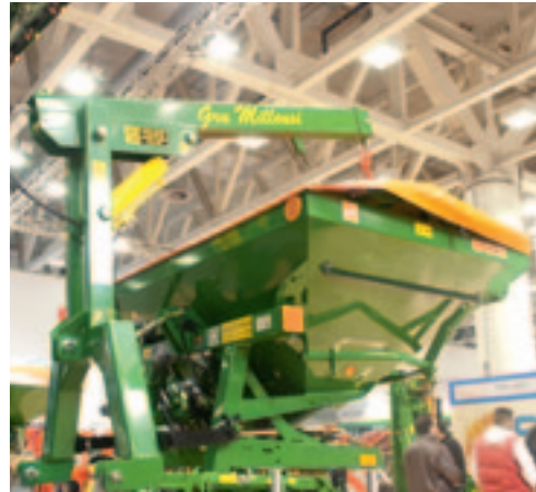
Bigbag-arpje Verschillende fabrikanten toonden op de Eima een telescopische arm voor montage tussen trekker en kunstmeststrooier. Met de arm kun je zonder verreiker of voorlader eenvoudig bigbags lossen boven de kunstmeststrooier.
