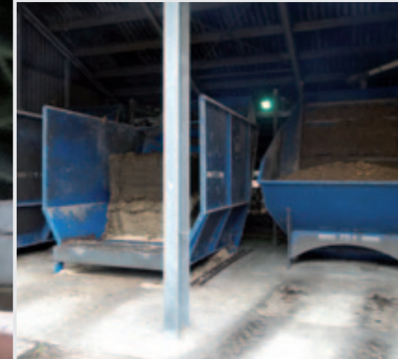
De voorraadbunkers vullen de robot automatisch met de verschillende voerproducten.
