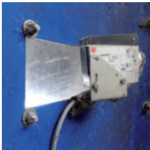
De sensor die de aanvoer van voer controleert, is een kwetsbaar onderdeel, omdat er de ruit vervuild raakt.
