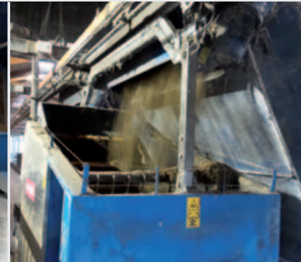
Het voer wordt vanuit de voerbunkers in de robot getransporteerd waarbij de robot meet hoeveel voer erin komt.
