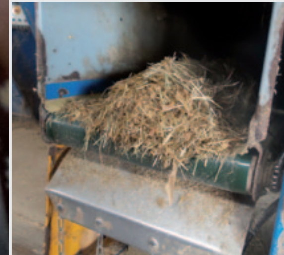
Het voer wordt met behulp van een pvc-losband voor het voerhek gedraaid.
