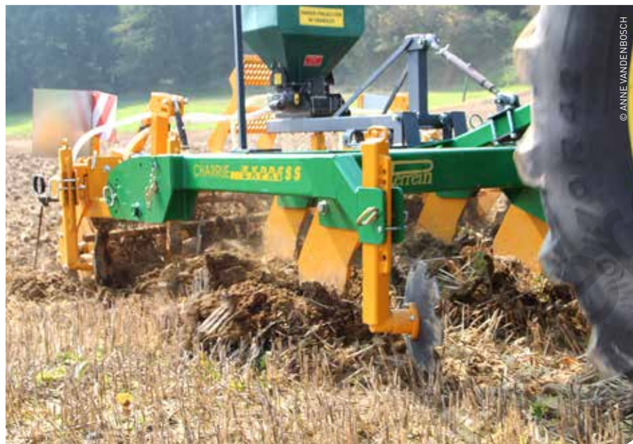
Zaaien in combinatie met niet-kerende grondbewerking spaart zowel de bodem als energie.
