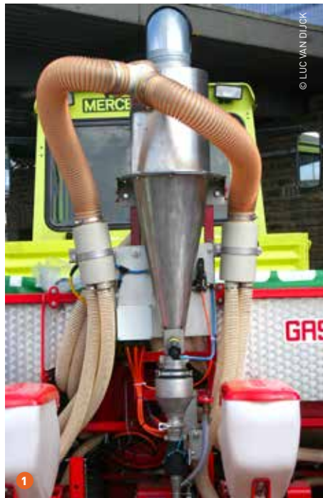
1 In het experimenteel SweepAir-concept wordt de lucht van het stof gescheiden en wordt het stof via een uitlaat in de grond gebracht. 2 Met het EasyFlow-systeem kunnen vloeibare producten veilig gemanipuleerd worden.
