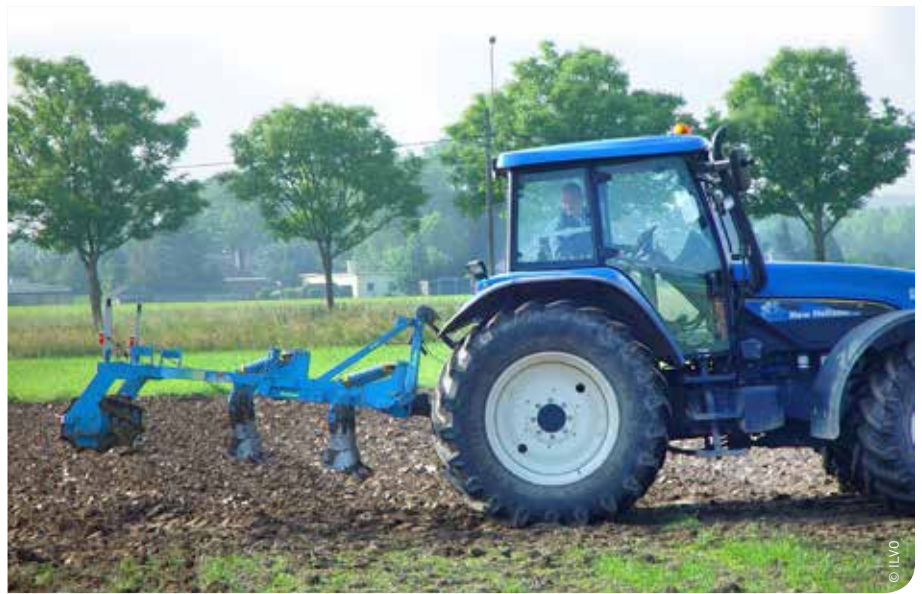
Met deze machine van Actisol kan je een niet-kerende grondbewerking uitvoeren.
