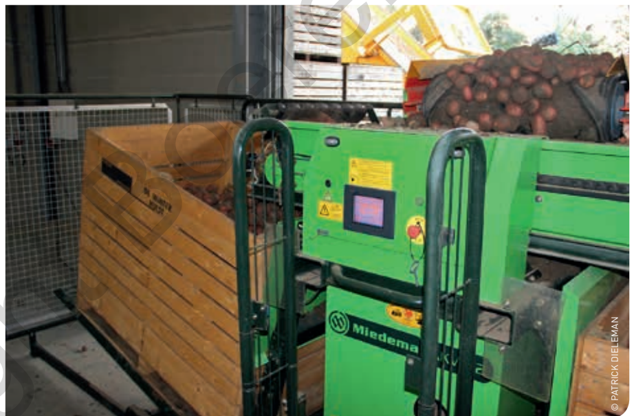
Een kistenvuller beperkt de valhoogte van de aardappelen, waardoor het gevaar op stootblauw verkleint.
