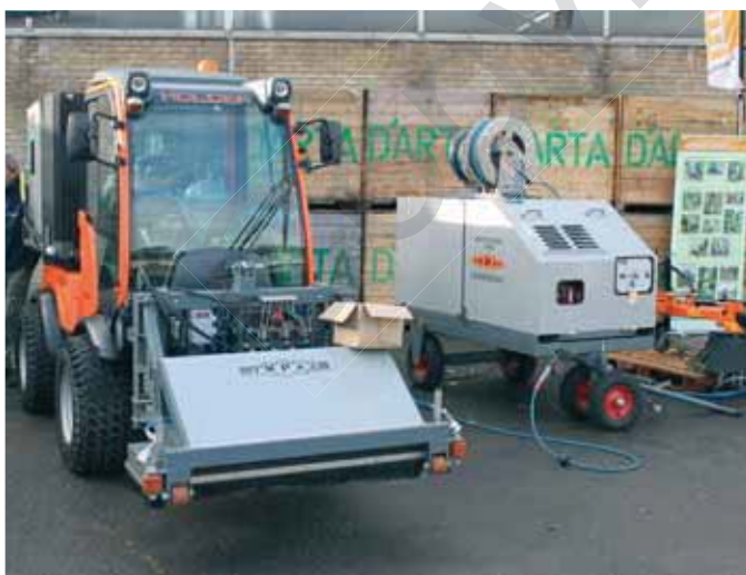
Machinale stoombehandeling voor de grotere oppervlaktes met daarnaast manuele toepassing voor de moeilijk bereikbare plaatsen
