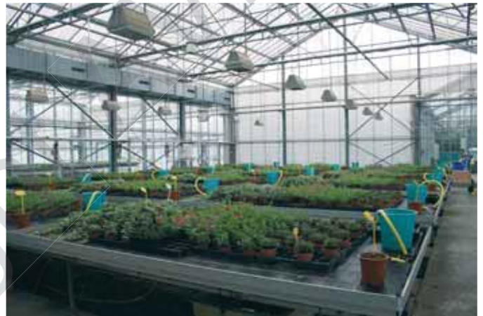
▲ Proefopstelling met 18 gesloten watercircuits
