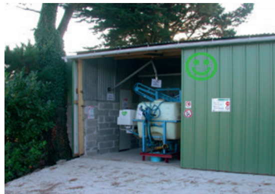
Het plaatsen van de spuitmachine onder een afdak voorkomt punt-emissies als gevolg van afspoeling door regen. Bron: Europees TOPPS-project.
