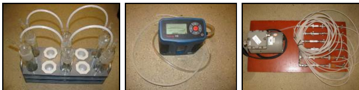
Figuur 2 Foto's van de natchemische meetmethode voor ammoniak. Links: twee sets van drie in serie geschakelde wasflessen. Midden: de flowmeter. Rechts: de elektropomp met zes pijpen met een kritisch capillair
