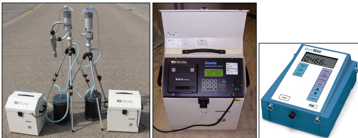
Figuur 1 Monsteraanapparatuur voor het meten van PM10 en PM2,5 d.m.v. gravimetrische filtratie. Links: een set apparatuur voor gravimetrische meting van PM10 (linker driepoot) en PM2,5 (rechter driepoot). Midden: detailfoto van de 'constant flow' monsternamemachine. Rechts: de DustTrak model 8520 voor continue/optische meting van PM10
