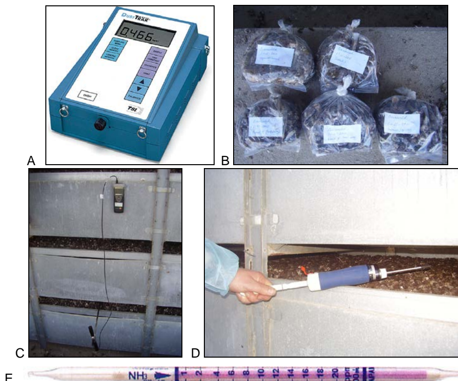
Figuur 1 Foto's van enkele metingen tijdens de bedrijfsbezoeken. A: de DustTrak model 8520. B: monsternamen van de mest ter bepaling van het drogestofgehalte. C: meting van de mesttemperatuur met staafthermometer en Testo meetapparaat. D: meting van de ammoniakconcentratie met handpomp en Kitagawa detectiebuisje. E: Kitagawa gas detection tube type 105SD (0.2-20 ppm)
