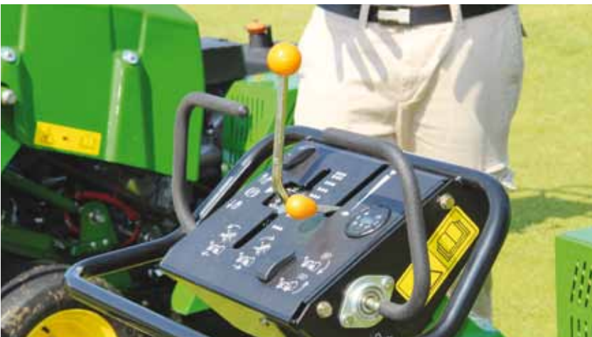
A40 met hendels: Een van de belangrijkste nieuwtjes aan deze beluchters is dat je nu tijdens het beluchten eenvoudig via een hendel op de bedieningsconsole de afstand tussen de gaten kunt verkleinen. Hierdoor kun je zonder oponthoud op bepaalde plaatsen meer lucht in de grond creëren.
