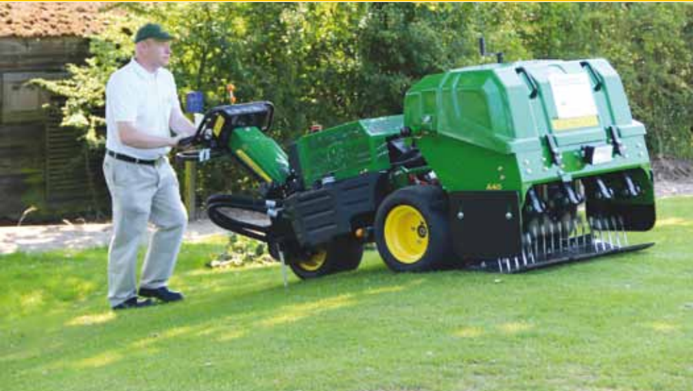
Nieuw is het bodemvolgende frame van de twee nieuwe beluchters, dat zorgt voor een consistente perforatie, zelfs op golvende terreinen. De beluchters zijn bodemvolgend gemaakt door middel van sensoren die de druk van de machine op de grond meten.
