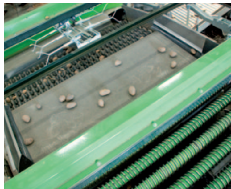
^ Tussenbandje Na de spiraalrollen is een tussenbandje gemonteerd. Dit bandje maakt het mogelijk om alle afvoerbanden (hoofdstroom, grond en ondermaat) op dezelfde hoogte en dezelfde zijde te laten uitstromen.
