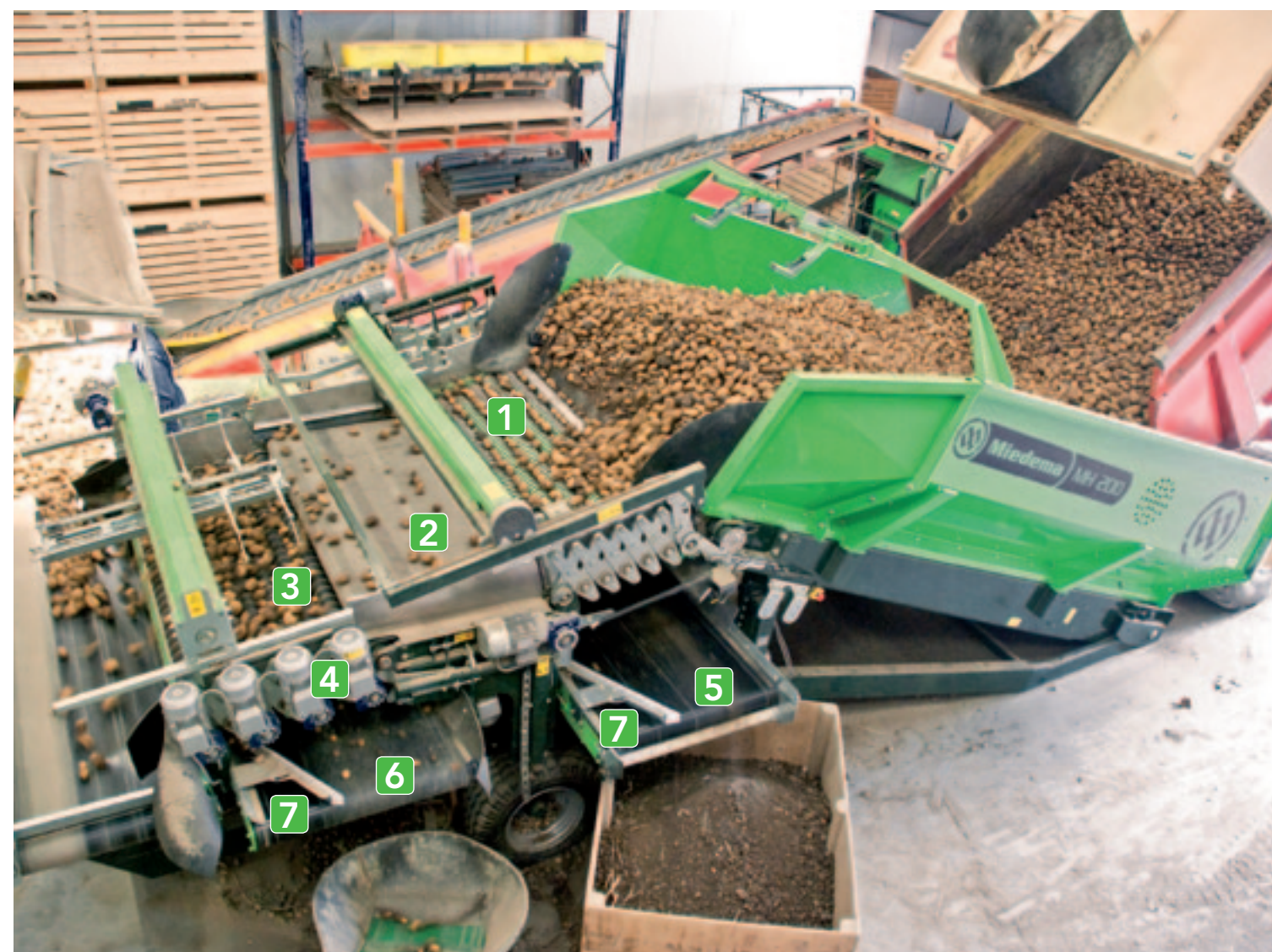
^ Miedema MH200 in detail Vanuit de bunker komen de aardappelen terecht op de spiraalrollen [1]. De spiraalrollen worden door twee motoren en kettingen aangedreven. Dan volgt een tussenband [2] die de aardappelen op de voorsorteerder [3] lost. De rollen van de voorsorteerder hebben voor de aandrijving elk een eigen motor [4]. De afvoerbanden voor grond [5] en de ondermaat [6] zijn bijna een meter breed. Met strijkers [7] kun je de afvoer smaller maken.
