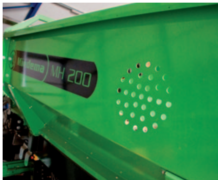
^ Kijkgaten In de zijwanden van de stortbak heeft Miedema handige kijkgaten gemaakt. Je hoeft geen rare toeren meer uit te halen om te controleren of de kieper al leeg is.
