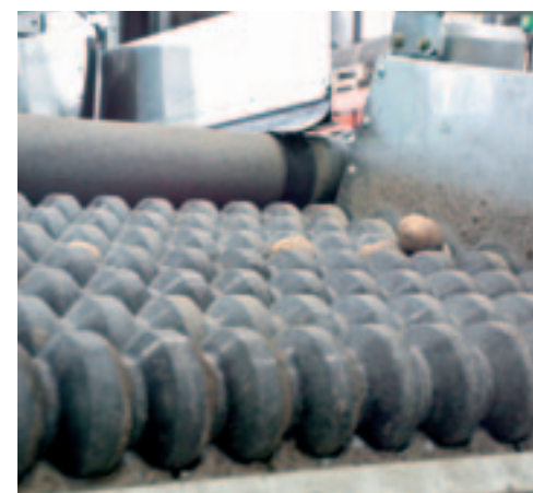
^ Voorsorteerder De harde kunststof rollen van de voorsorteerder worden afzonderlijk aangedreven. Met twee elektrische cilinders stel je de maat in.
