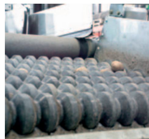
^ Voorsorteerder De harde kunststof rollen van de voorsorteerder worden afzonderlijk aangedreven. Met twee elektrische cilinders stel je de maat in.
