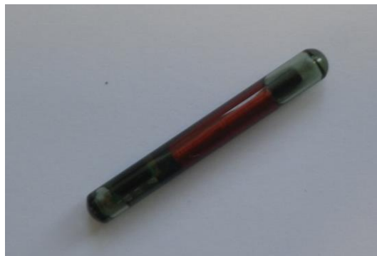
Afbeelding 3.1: 32 mm HDX PIT-tag.
