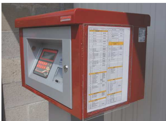
Op elke beveiligingsunit hangt een lijst met de machines en het bijbehorende registratienummer. Dit moet bij elke tankbeurt worden ingevoerd.
