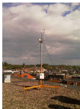
Figuur 1.10 Links: Scintillometerpad tussen het Sint Franciscus Gasthuis (Lat/Lon 51.56478/4.27747, hoogte 51 m) en het Erasmus MC (Lat/Lon 51.54632/4.28128, hoogte 77 m) in Rotterdam. De afstand tussen zender en ontvanger is 3451 m, oriëntatie \sim 180^\circ . Rechts: opstelling voor verdampingsmetingen boven op een appartementencomplex aan de Ingenieur J.P. van Muijlwijkstraat in Arnhem (51°59'4.97"N, 5°55'5.73"E) http://www.climatexchange.nl/sites/arnhem/index.htm . Het meetsysteem bestaat uit 3D ultrasonische anemometer (Gill R3-50) in combinatie met een snelle open-pad infrarood gas analyzer (Li-Cor LI-7500) bevestigd aan de top van een 4 m hoge mast.
