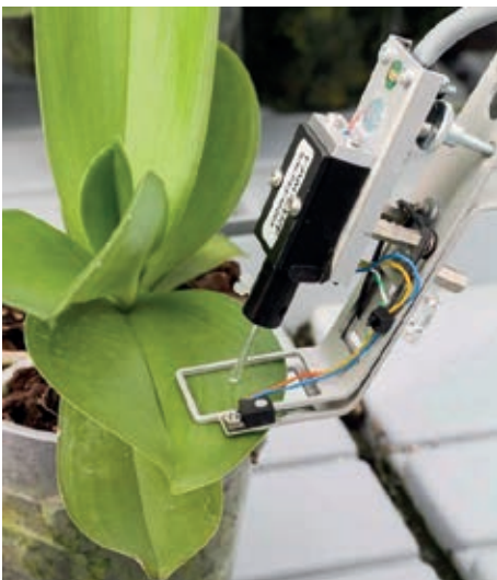
Figuur 36 Experimentele Quad-PAM van Gademann Instruments op Phalaenopsis blad in de daglichtkas.
