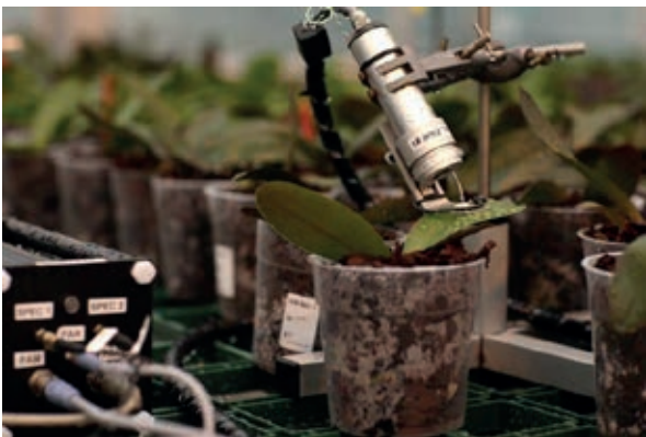
Figuur 1 De Spectro-PAM meter #1 op het blad van de cultivar Golden Beauty.
