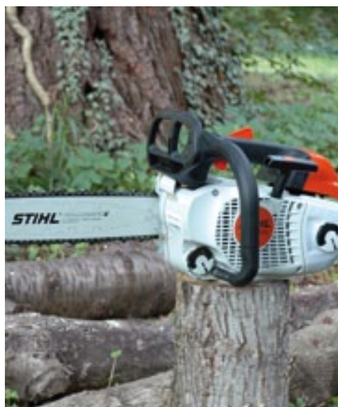
Stihls lichtste motorkettingzaag, de MS 201, (3,9 kg zonder blad, ketting en met lege tank) is nu standaard voorzien van het elektronisch motormanagement M-Tronic.
