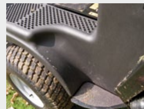
Je stapt op tussen het voorwiel en het vleugeldek. Daardoor hoef je geen draai te maken op het platform.
