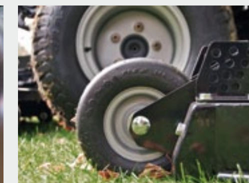
Het voorwiel van de vleugeldekken stuurt niet. In werkstand zitten ze in lijn met de voorwielen, dat minimaliseert slepen.
