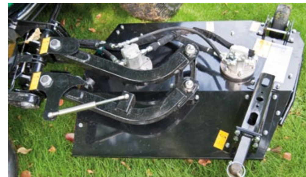
Elk mes heeft een eigen hydromotor. Dat neemt beperkingen weg bij het opklappen en bij het in- en uitschakelen. De machine bevat slechts één getande riem. De vleugeldekken kunnen uitwijken bij een aanrijding. Een gasveer dwingt het dek vervolgens terug naar de juiste positie.
