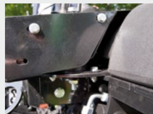
Het bestuurdersplatform staat op vier rubberblokken. De stuurkolom is op het platform gemonteerd.
