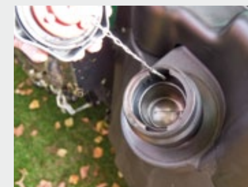
De vuldop van de dieseltank beschikt over een extra klep die lekken voorkomt bij werk op taluds. Een veer houdt de klep dicht.
