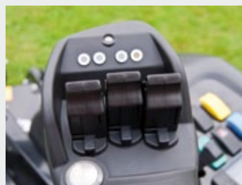
De bediening en inschakeling van de maaidekken wijst zichzelf. Bij heffen schakelen de maaidekken automatisch uit.
