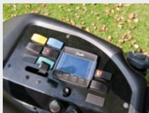
Via de display in de zijconsole kun je gegevens oproepen en instellingen veranderen. Een veiligheidscode instellen is mogelijk.
