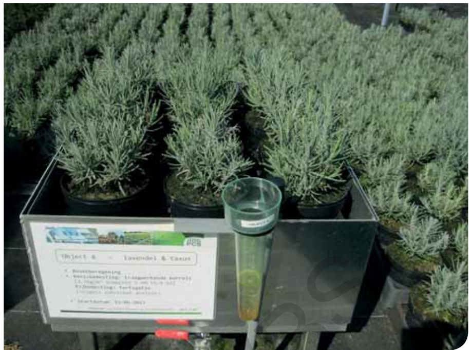
▲ Door planten in een lysibak te plaatsen kan het drainwater opgevangen, gemeten en geanalyseerd worden. De pluvio- of regenmeter op de voorgrond zorgt voor een correcte registratie van de watergift (regenval, irrigatie en fertigatie).
