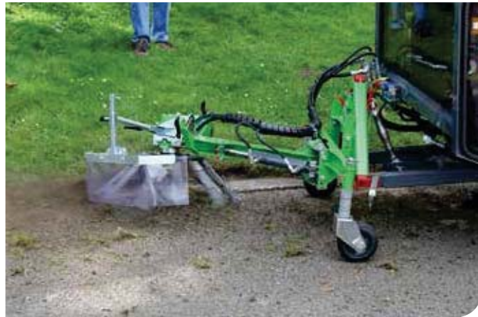
Mechanische onkruidbestrijding met borstel op werktuigendrager
