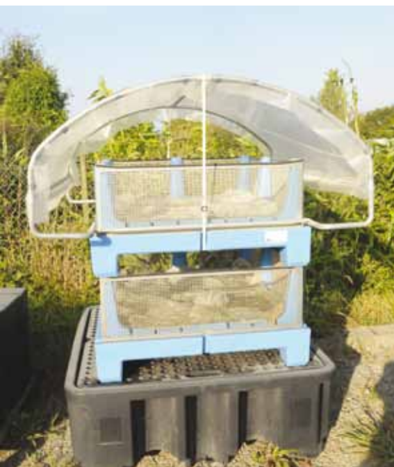
Installatie om spuitvloeistof af te breken.
