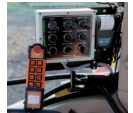
Afstandsbediening Er is een bediening in de trekkercabine en een afstandbediening. Rechts de printer voor het maken van weegbonnen.
