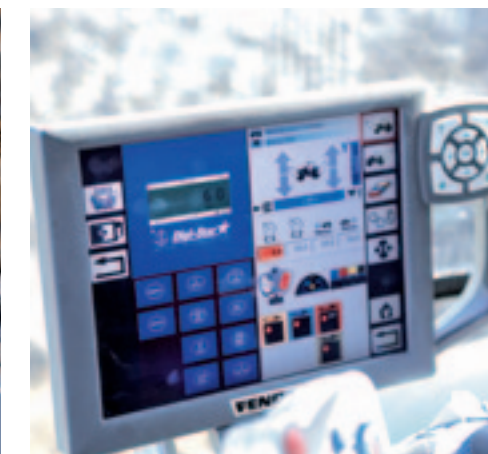
Weegsysteem Het weegsysteem van Digi-Star weegt met vier sensoren onder de twistlocks. Je bedient hem via een Isobus-terminal.
