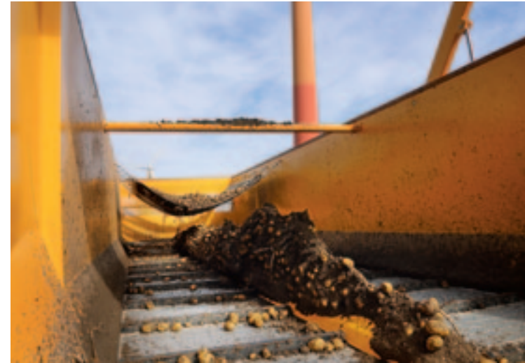
Bodemat De bodemat bestaat uit twee delen en is voorzien van een zware rollenketting en zware kunststof bunkerlatten. Voor aardappelen en uien is een valbreker gemonteerd.
