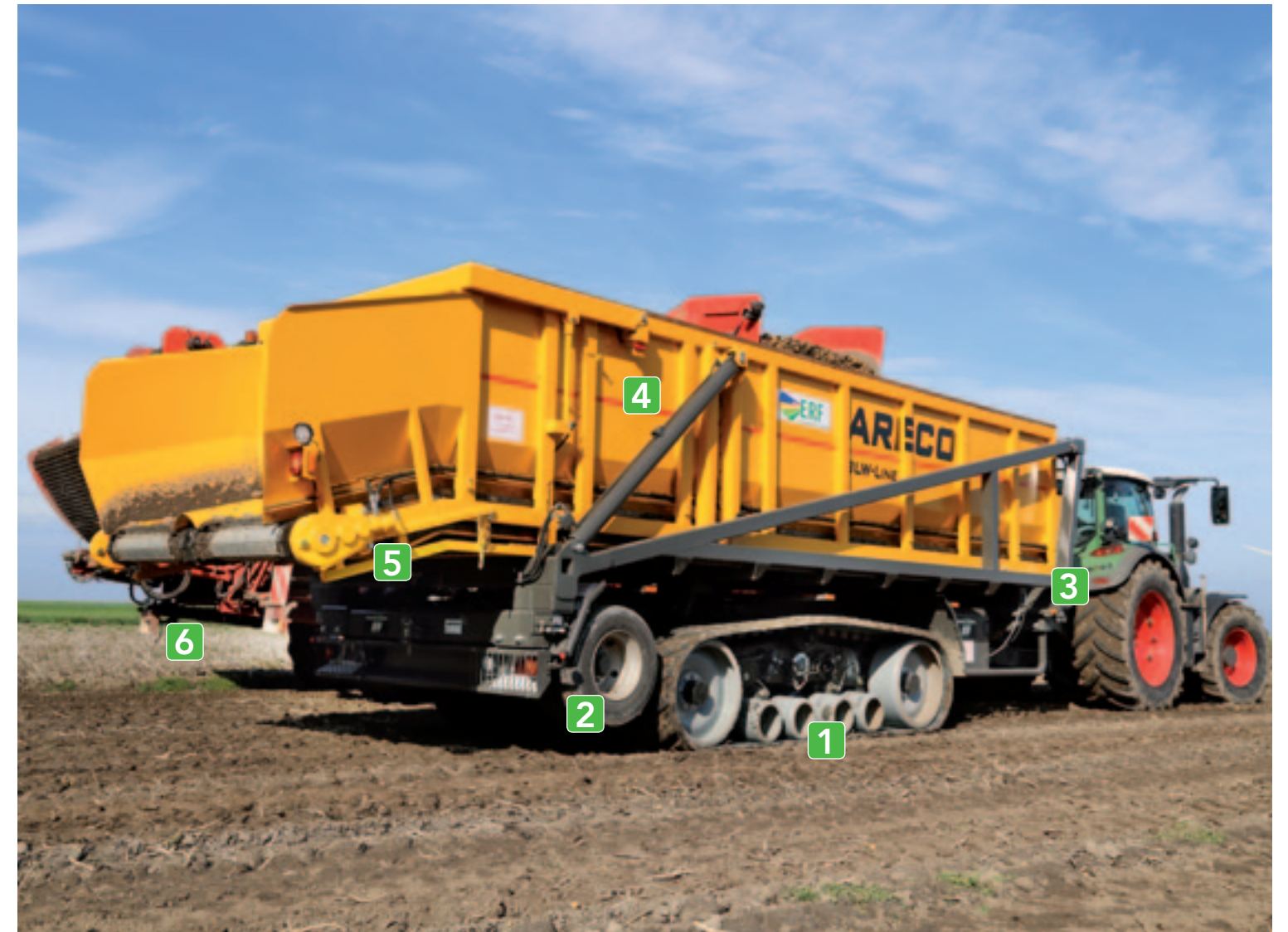
Areco BLW-Line in detail Het Camoplast rupsonderstel [1] heeft een gezamenlijke voetafdruk van 5,16 vierkante meter. Op de weg rijdt de wagen op een enkele transportas [2]. De bak staat op twistlocks [3] en is uitwisselbaar met een meststrooier. De bak [4] is een verzwaarde uitvoering met hogere zijwanden van 1,40 meter waarvan de hydromotoren en aandrijfkasten [5] zijn verzwaard. Aan de achterzijde bevindt zich extra werk- en breedteverlichting [6].
