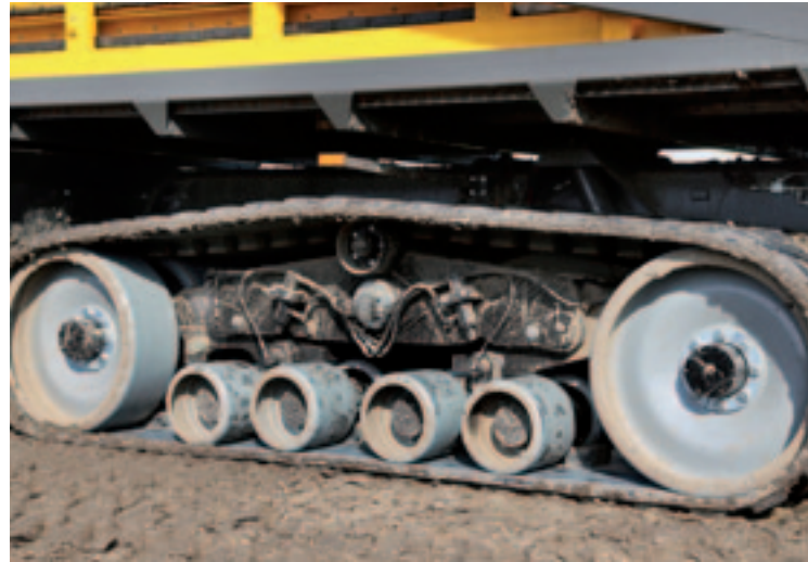
Rupsen BLW paste het rupsonderstel zelf aan. Een cilinder duwt de achterkant naar beneden bij het nemen van bochten, zodat de trekkkracht wordt verlaagd. Op de weg drukken cilinders de pendelende looprollen vlak.
