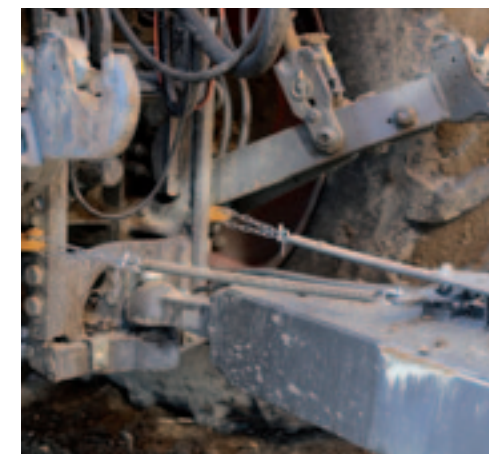
Stuurcilinder Een sensor stuurt de hydraulische cilinders aan die het rupsonderstel naar beneden drukken in de bochten.
