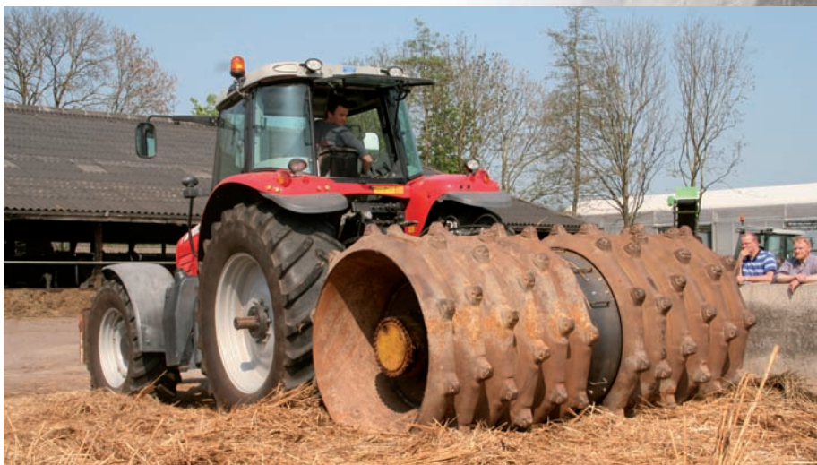
De nieuwe kuilverdeler van mechanisatiebedrijf De Bruin is extra zwaar. De punten op de walsen verdelen het gras en zorgen voor een hoge druk.
