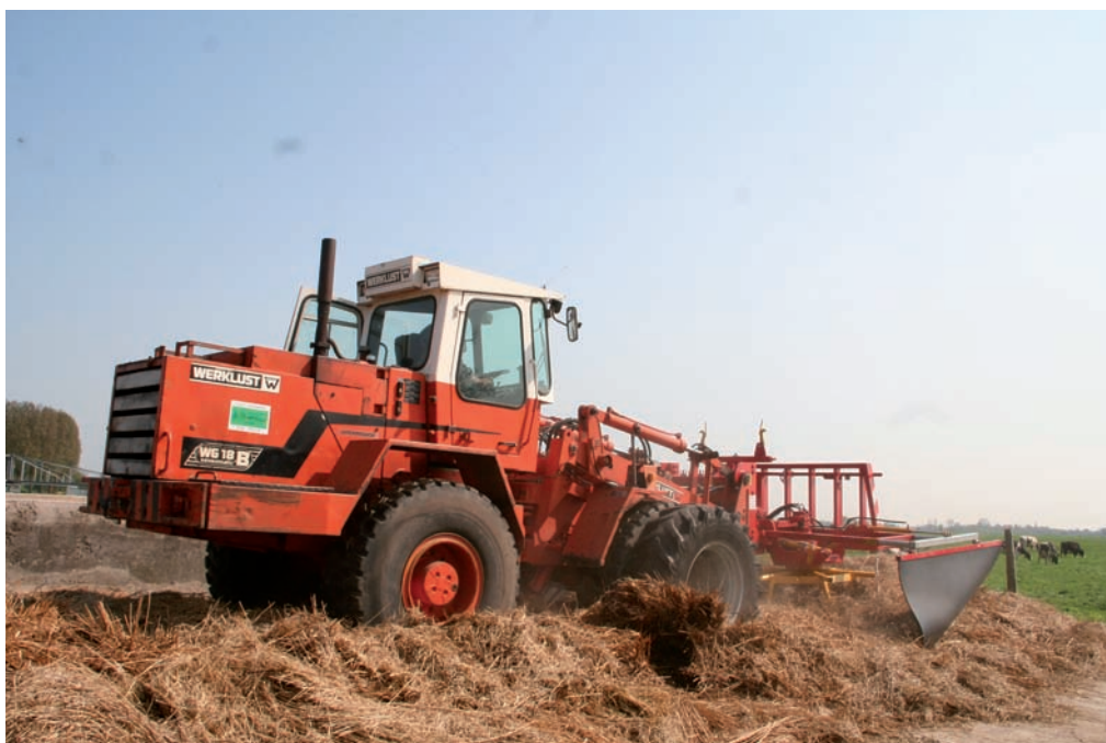
De kuilverdeler van Kemp Machines op de shovel combineert een hoog eigen gewicht met snel verdelen en verdichten.
