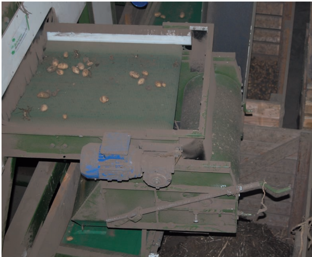
De kluiten- en loofscheider nemen veel werk uit handen bij het lezen.
