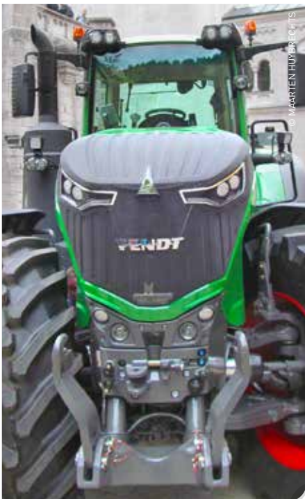
De brede neus bij de Vario 1050 is nodig om de koelementen te kunnen plaatsen, maar het zicht vooraan op de frontwerktuigen wordt overgenomen door een camera-oog.
