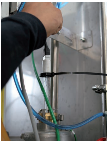
In het UV Pure-systeem wordt de melk langs drie UV lampen gepompt.
