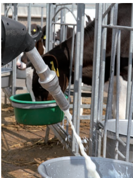
Sensoren meten hoeveel melk er door het pistool gaat.
