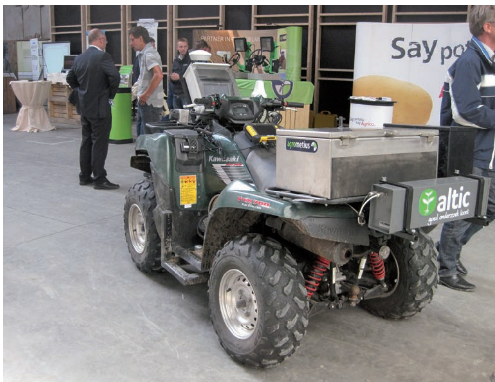
De quad rijdt met behulp van RTK-gps over het perceel en brengt de bodemeigenschappen in kaart.
