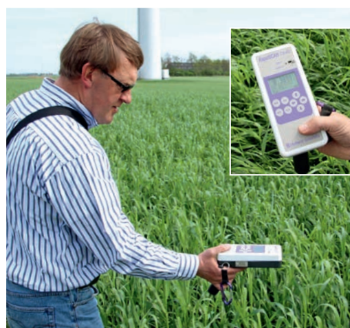
Herman Krebbers in actie met een gewasreflectiesensor. Eiwitbepaling is hiermee in de toekomst ook mogelijk
