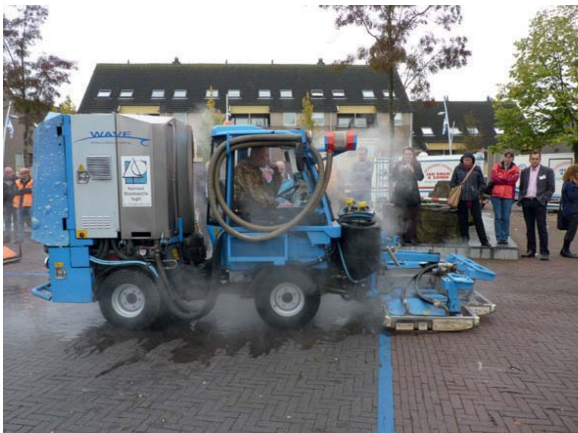
Demonstratie van de heet water-techniek voor onkruidbestrijding op het plein van de Schoon Water gemeente Bladel.
