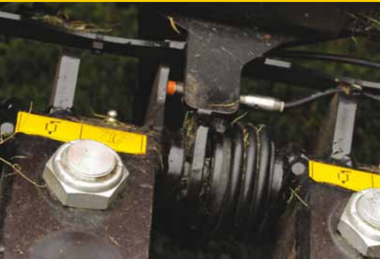
Het in- en uitschakelen van de dekken gebeurt via een optisch oog. Hier het rode puntje.
