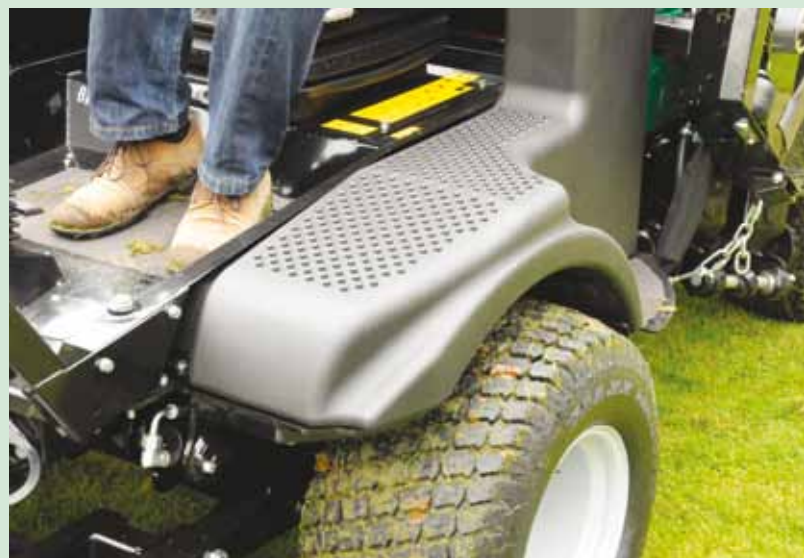
Natuurlijke koeling van de hydraulische olie in het linkerspatbord.
