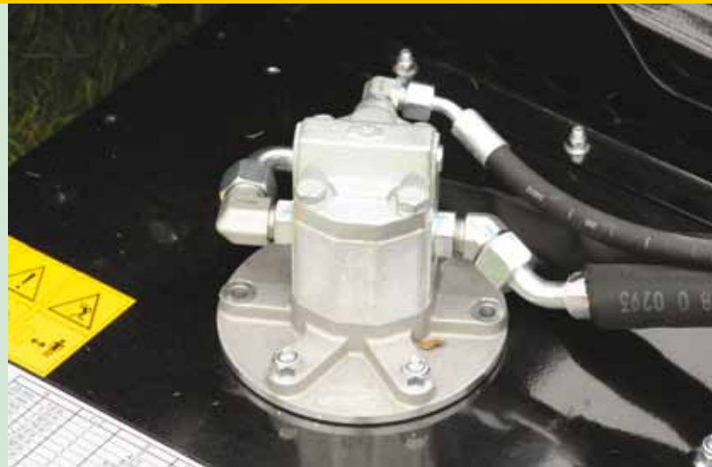
De hydromotoren zijn direct op snijmesses gemonteerd.
