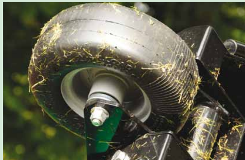
Zo weinig mogelijk wielen op het dek zijn meedraaiend – scheelt weer in onderhouds- en slijtagepunten
