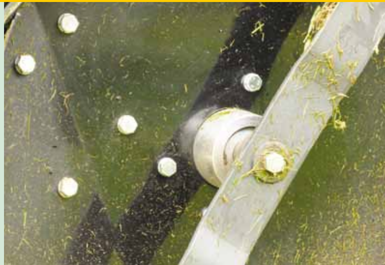
De dekken zijn gemaakt op werk in openbaar groen met veel kans op 'blessures'. Daarom zijn ze niet gelast, maar gebout.
